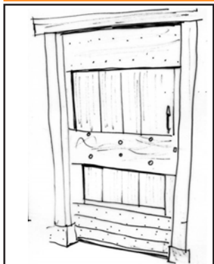
Porte à un seul battant composée de planches verticales et horizontales.
