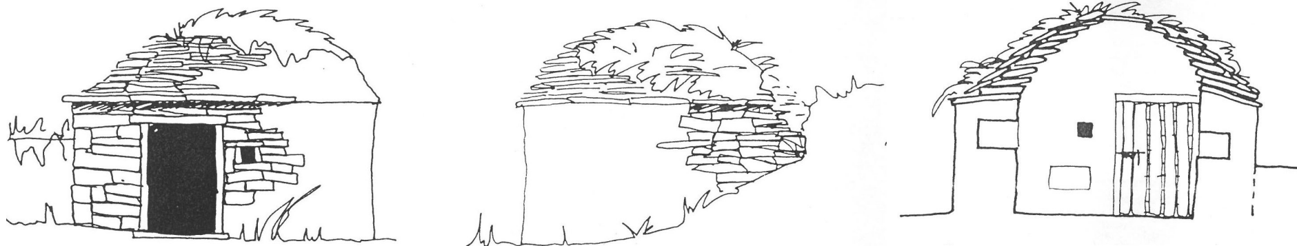
Façades et coupe d'un orry de Goutets. Le tas de charge est, dans ce cas, recouvert de végétation.
