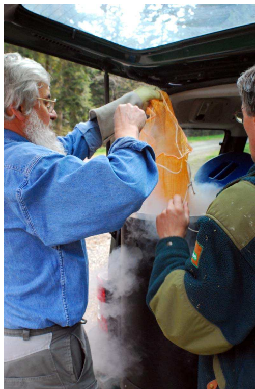
Conservation des échantillons dans un Dewar rempli d'azote liquide à -180^{\circ}\text{C}
