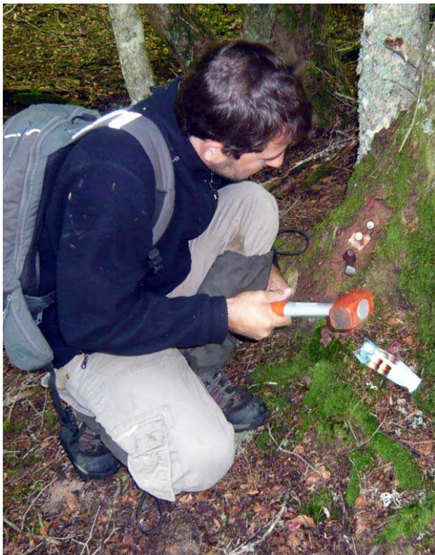
Prélèvement sur un sapin de 3 échantillons de cambium stockés dans une feuille d'aluminium
