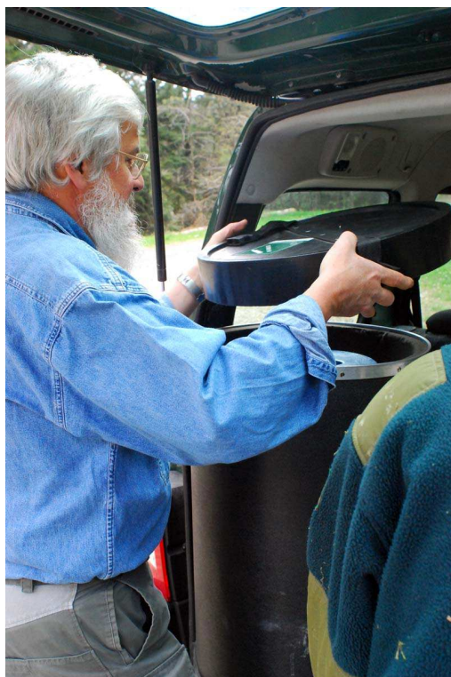
Conservation des échantillons dans un Dewar rempli d'azote liquide à -180^{\circ}\text{C}
