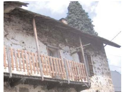
En milieu rural, le toit débordant est systématique. Il permet de protéger la façade principale et les balcons des intempéries, en particulier l'accès aux portes d'entrée.
