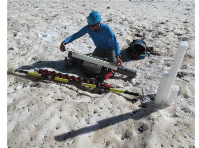
Mesure de densité par carottages, 2018 © PNR PA
