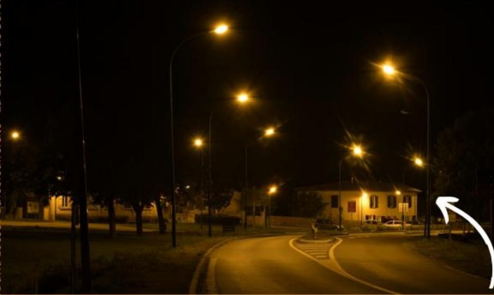
En entrée de ville, plus l'éclairage est intense, plus l'effet d'éblouissement des automobilistes est important. Réduire la quantité d'éclairage, la hauteur des mâts et la puissance des ampoules (ici SHP 100 W) permet de diminuer cet effet.
